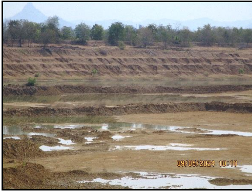
ภาพที่ 2.2 การเปิดหน้าเหมืองในลักษณะขั้นบันได
